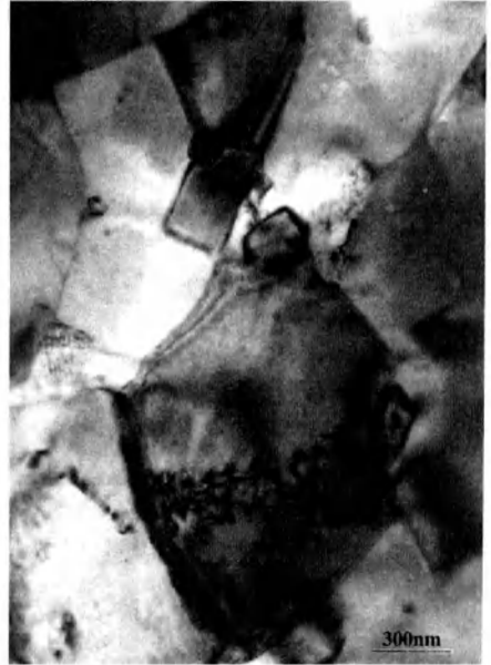
Рис. 4.51. Полученное методом дифракционного контраста изображение в светлом поле окиси алюминия, наполненной частицами SiC.
