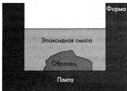
Рис. 3.18. Для удобства образцы часто помещают в полимерную форму лицевой поверхностью вниз.
