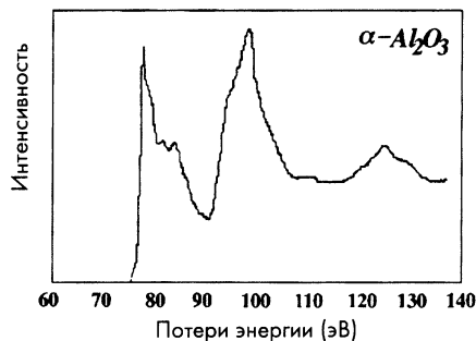
Рис. 5.17. L_{2,3} – край (а) \gamma\text{-Al}_2\text{O}_3 (мета-стабильная фаза с кубической решеткой) и (б) \alpha\text{-Al}_2\text{O}_3 (устойчивая фаза с ромбоэдрической структурой) (I. Levin).
