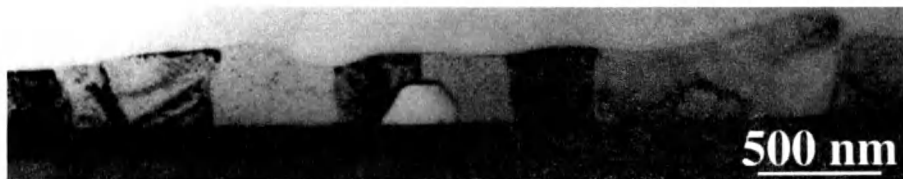
Рис. 4.60. Изображение многослойного образца Al/TiN/Ti/SiO_2/Si в светлом поле просвечивающего электронного микроскопа при малом увеличении. Видны отдельные зерна Al , а также открытые и закрытые поры в слое Al .
