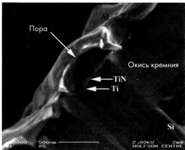
Рис. 4.58. Поверхность разрыва многослойного образца, состоящего из гофрированной кремниевой подложки, на которую нанесены слои Al/TiN/Ti . Видны открытая пора и следы пластической деформации алюминия.
