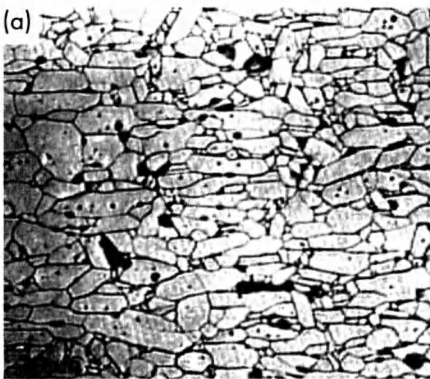
Рис. 3.39. Полированная окись алюминия. Термообработка при 1200°C в течение 30 мин позволяет получить высококачественную поверхность (а). Термообработка в течение 2 часов (б) улучшает видимость межзеренных границ.
