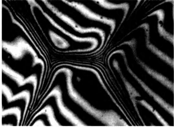
Рис. 3.32. Двулучевая интерференционная картина, обусловленная углублениями на границе зерен.
