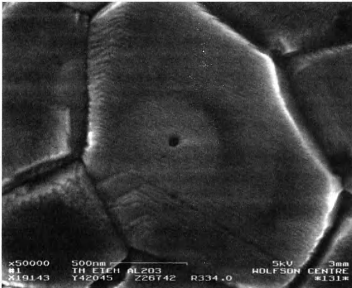
Рис. 7.17. Разрешение оптического микроскопа после отжига керамического образца обычно ограничено величиной 1 мкм. Использование растрового электронного микроскопа в режиме вторичных электронов позволяет значительно улучшить разрешение.
