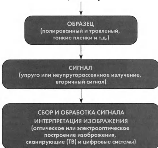
Рис. 1.2. Микроструктурные исследования основаны на взаимодействии какого-либо вида излучения с объектом. Обычно используют видимый свет, рентген или пучок высокоэнергетических электронов. Если рассеяние является упругим, изображение может быть сформировано при помощи оптической системы. При неупругом рассеянии можно получить двумерное растровое изображение исследуемого образца (как на телеэкране).
