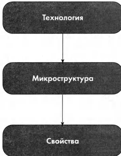
Рис. 1.1. Микроструктура материала определяется его химическим составом и технологией получения. В свою очередь, она определяет технические характеристики материала.
