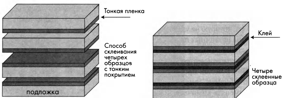
Рис. 4.59. Схема изображение подготовки образца для ПЭМ.
