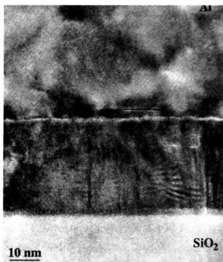
Рис. 4.61. Больше увеличение того же многослойного композита в просвечивающем электронном микроскопе. Наблюдается фазовый контраст в области границы раздела слоев TiN и Ti .
