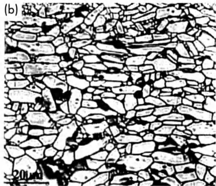
Рис. 3.39. Полированная окись алюминия. Термообработка при 1200°C в течение 30 мин позволяет получить высококачественную поверхность (а). Термообработка в течение 2 часов (б) улучшает видимость межзеренных границ.
