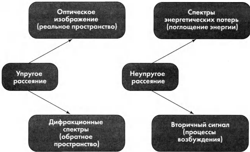
Рис. 1.3. Упругорассеянный сигнал может быть собран оптической системой для формирования реального трехмерного изображения, однако можно анализировать и дифракционные максимумы в обратном пространстве. Процессы неупругого рассеяния позволяют анализировать энергетические спектры первичных электронов, а также сигналы возбуждения вторичных электронов и рентгеновского излучения.
