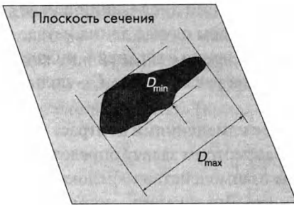
Рис. 7.15. Максимальный и минимальный размеры частицы, характеризующие отношение длины к толщине.
